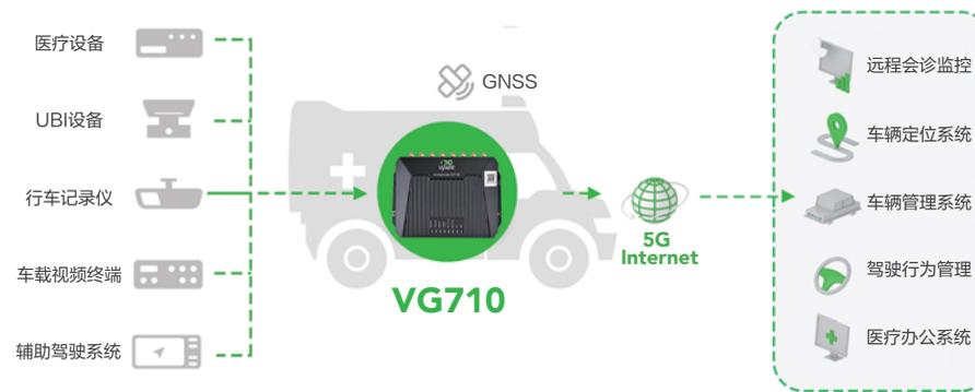
映翰通车载网关VG710连接车载医疗设备和办公设备，获取用户身份信息，采集医疗车载设备数据，监测用户体征数据，自动生成病历和检测结果，上传到医疗办公平台为用户智能建档，对需要入院病人，医疗中心可以依据这些信息进行院前的初步诊断和分诊分级。此外，车载网关连接车载多媒体通信系统与医疗中心的远程诊断系统，保障高清音视频数据可靠稳定传输，同时医疗中心实时远程监控患者体征信息，便于远程诊断指导和专家会诊。
