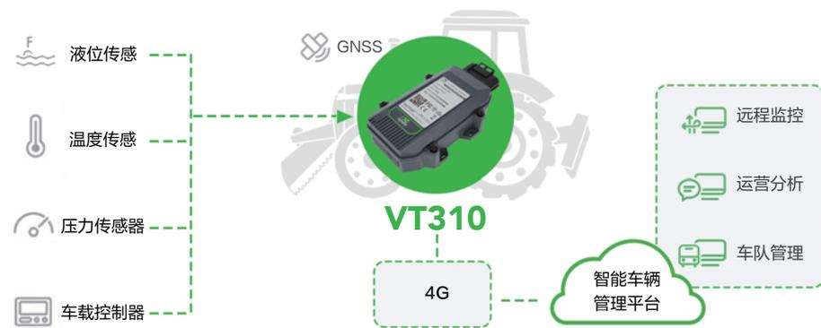
映翰通车载追踪网关VT310为车辆提供高速安全的4G网络，通过丰富的接口将农机车载设备与发动机相关设备统一接入网络。
